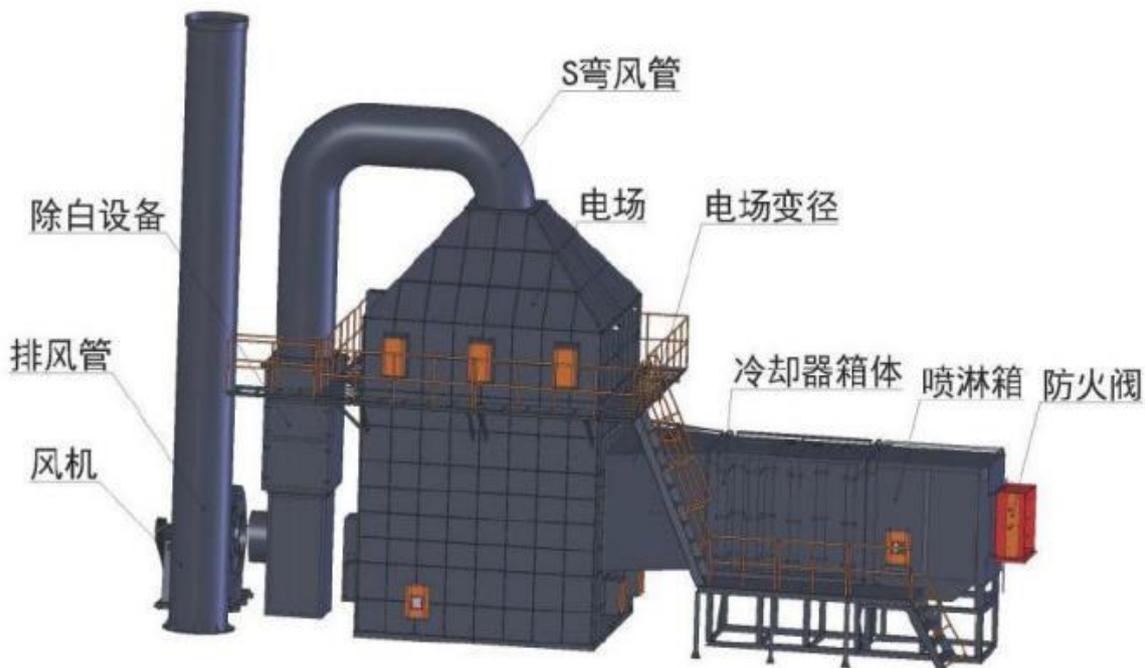
图 6.2-5 水喷淋+二级静电净化装置原理示意图
